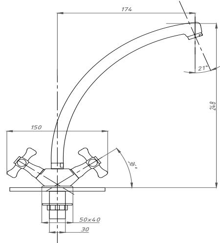
**Назначение:** смесители предназначены для санитарно-технических приборов (умывальников, рукомойников, моеч, раковин, ванн, душа и аналогичных).
